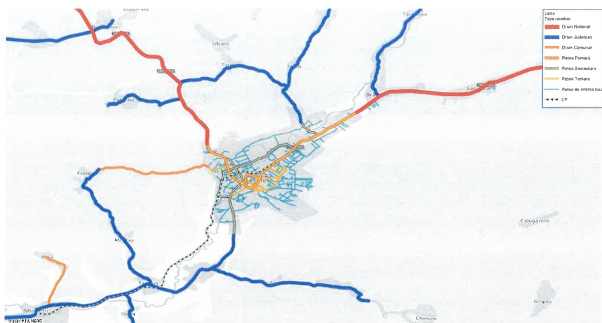
Figură 3-10 - Structura rețelei rutiere în cadrul modelului de trafic pentru municipiul Odorheiu Secuiesc
