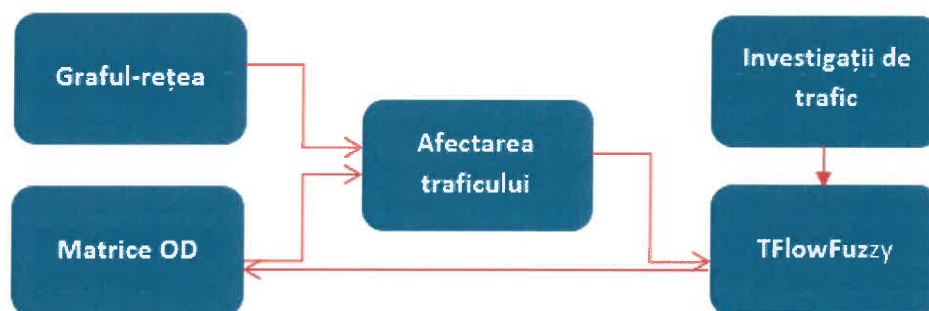
Figură 3-17 - Schemă a logică a procesului de calibrare utilizat
